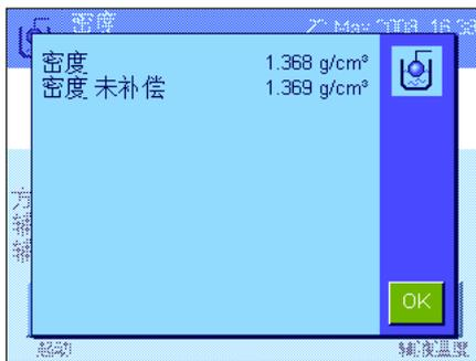
天平此时开始测定固体的密度并显示结果。根据您的结果显示屏所做的设置，显示补偿结果、未补偿结果或同时显示二者（参见第 10.3.5 节）。
