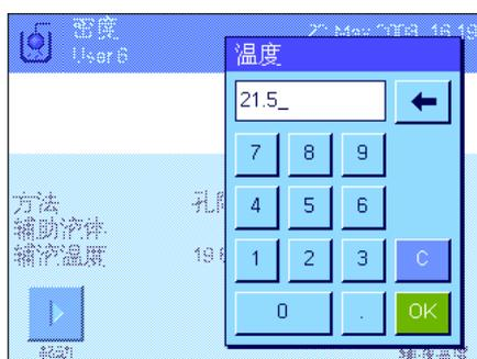
如果您用水或酒精作为辅助液体，请输入其温度（用“辅助温度”功能键）。（天平存储了这两种物质在 10 °C 到 30 °C 温度范围内的密度表中，另请参阅第 10.7 节和第 10.8 节）。左边的插图显示了对应的输入字段（以 °C 为单位输入，带 1 个小数位）。
