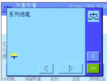
在称完最后一个样品之后，会显示一条信息，确认对系列中所有样品的皮重和初始称量工作已经完成。
