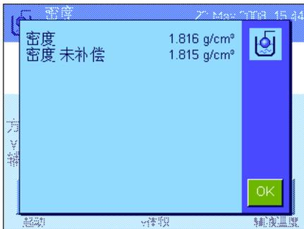
天平此时开始测定粘稠物质的密度并显示结果。根据您的结果显示屏所做的设置,显示补偿结果、未补偿结果或同时显示二者(参见第 10.3.5 节)。如果已连接一台打印机,则可以按《☰》键来打印输出符合规格的密度测定结果的报告(见第 10.3.8 节)。结果将一直保存至用相同方法完成下一次密度测定为止,因此可以在需要时再次打印输出。
