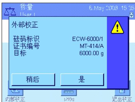
**仅限于自动外部校正:** 如果您在系统设置中指定天平应自动请求校正 (参见独立的超越系列 XP 天平操作说明书 第 3 部分, 第 3.5 节), 左边的窗口将在选定的时间出现。如果您想要执行校正, 请按“是”以启动上述校正过程。另一方面, 如果您按“稍后”的话, 将在 15 分钟后提示您进行校正。最后选定的校正砝码始终用于自动外部校正。**注意:** 显示屏右上角中表示自动外部校正的小质量图标在成功完成校正后, 或者在第二次请求时决定不进行校正 (“否”)后将被删除。
