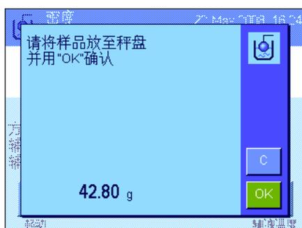
按“启动”功能键以开始密度测定。天平执行一次自动去皮操作，然后提示您将固体放在天平中（首先在空气中称量）。
