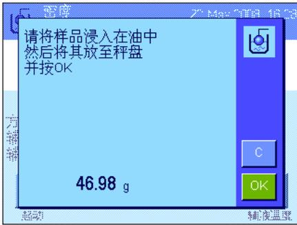
此时天平将提示您将固体短暂浸入油浴中，然后再放回原位（在空气中第二次称量）。
