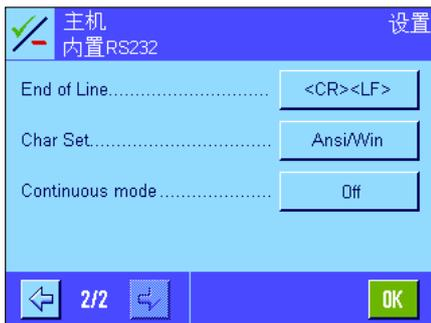
**注意:** 可以在这些产品附带的文件中找到关于可选接口和不同外设的详细信息。如果您已激活一台设备, 则可以用“定义”按钮来设定用于和该设备通信的接口参数, 即 baud rate (波特率), data forma (数据格式), stop bits (停止位), handshake (信号交换), end of line character (行结束字符), character set (字符集) 和 “Continuous mode” (连续模式) (仅用于“主机”外设)。
