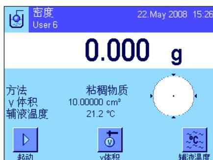
在适合这种方法的特定应用程序设置中，选择“粘稠物质”（见第 10.3.2 节）。激活相关功能键和信息字段（见第 10.3.6 节和第 10.3.7 节）。左边的示例显示了用  $\gamma$  球测定粘稠物质密度时的设置。注意：这种密度测定方法不需要使用左边示例中激活的“辅液温度”功能键，以及具有相同名称的信息字段。但如果您需要，也可以用这个功能键输入当前环境温度，以便将其打印在作为测定密度的温度记录的报告上。
