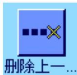
统计功能激活后，所有称量结果都将自动传送给统计程序（最多可达 999 个值）。如果因失误将不正确的结果加入到统计数据中，您可以用“删除上一个”功能键将其删除。不过，您只能删除包含在统计数据中的最后一个结果。将不正确的结果删除后，该键将处于停用状态，直到下一个结果被传送到统计程序中，才可恢复使用状态。
