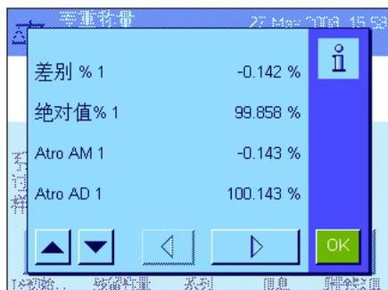
如果一个样品的结果占据了好几个窗口，您可以使用屏幕左下方的滚动按钮，在各个结果窗口之间进行切换。
