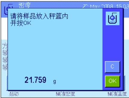
天平将保存称量结果，然后提示您将固体浸入辅助液体中。
