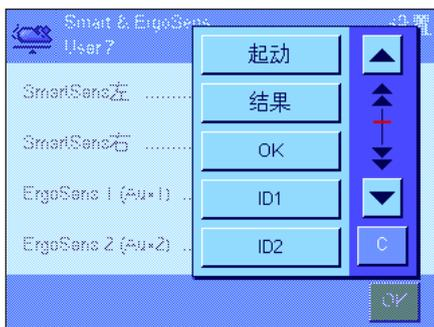
“起动”和“结果”可模拟具有相同名称的功能键。“OK”可模拟按动态称重程序对话框（而不是在菜单中）相同名称的按钮以确认输入和操作。如果这些设置中有一个被激活，对应传感器下的状态栏中的绿色“F”（功能）符号将点亮。
