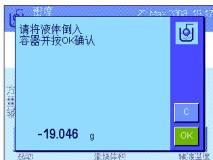
在扣除液体密度测量块皮重后，天平会提示您将要测定其密度的液体倒入一个容器中。如果您正在使用密度测定组件选件，请按照该选件随带的说明书进行操作。如果您正在使用天平下挂称量吊钩，请将装有液体的容器放在吊钩下。在任何一种情况下，均应确保至少将液体密度测量块浸入液体中 1 厘米深处，并确保容器中没有气泡。
