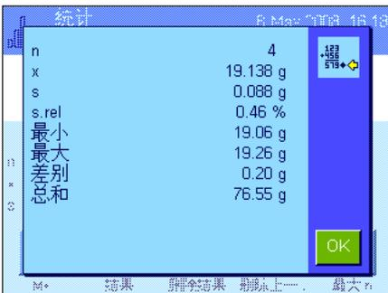
结果窗口包含称量系列的结果（显示选择用于打印结果的信息，参见第 6.3.5 节）。有关单位、分辨率和显示值的精度，请参考第 6.4.3 节中的注意事项。
