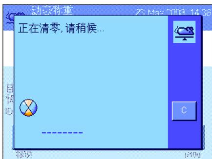
当您拿走重物后（假设“自动皮重”功能已激活），显示值将自动复位为零。随后，天平准备进行下一次称量。
