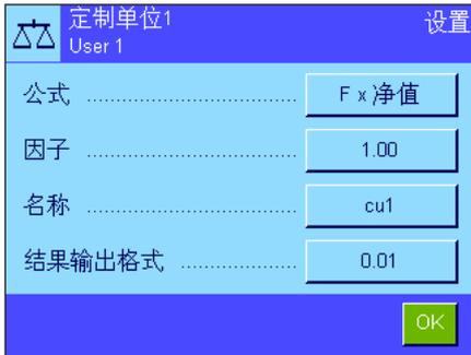
在“定制单位1”和“定制单位2”两个菜单中都可以定义定制称量单位。因此，一旦称量结果被记录即可立即进行计算（如对于表面积或体积）。定制称量单位可用于所有菜单和可以选择称量单位的输入字段中（但在手动输入皮重值时不可用）。
