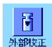
按这个功能键可触发天平用外部校正砝码进行校正。虽然这个操作可以随时执行,但您还可以在系统设置中指定天平在特定周日的特定时间发出校正提示(参见独立的超越系列 XP 天平操作说明书 第 3 部分,第 3.5 节)。注意:根据所在国家的具体法规,不可在认证天平上使用外部砝码进行校正。
