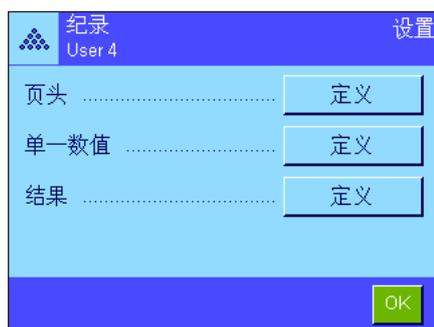
用于定义记录页头, 打印各个数值和结果的三个子菜单包含计件用附加设置, 这些设置将在下面进行描述。
