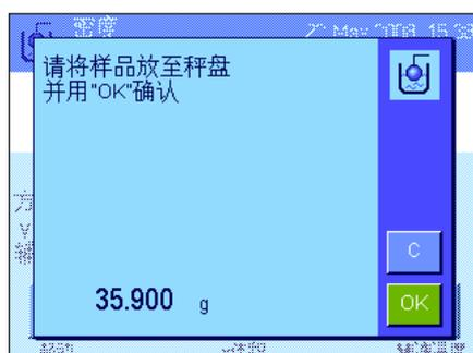
按“启动”功能键以开始密度测定。天平随后提示您将样品放在天平上（不带  $\gamma$  球）。
