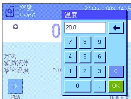
如果您用水或酒精作为辅助液体，请输入其温度（用“辅助温度”功能键）。（天平存储了这两种液体在 10 °C 到 30 °C 温度范围内的密度表中，另请参阅第 10.7 节和第 10.8 节）。左边的屏幕截图显示了对应的输入字段（以 °C 为单位输入，带 1 个小数位）。
