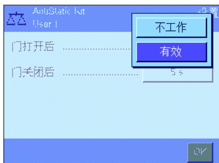
在这个菜单选项中, 您可以对去静电装置的工作原理进行设置。
