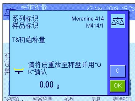
等到天平提示您装载第一个样品的称量容器（皮重）当您完成了这一操作后，按“OK”。在天平测定皮重的同时，会显示一条对应的信息。
