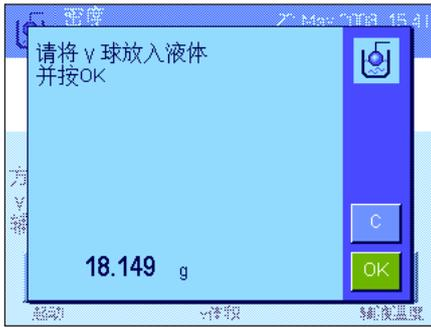
扣除样品皮重后,天平会提示您将  $\gamma$  球浸入样品物质中。被  $\gamma$  球排开的物质的质量显示在窗口的左下角。按“OK”以确认质量值。
