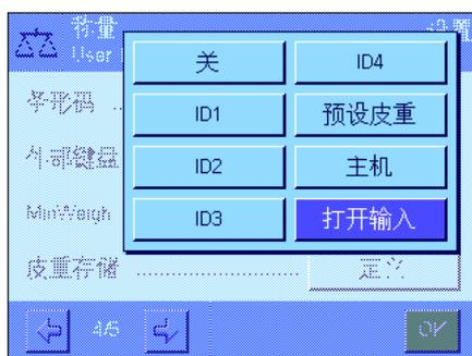
**“关”：** 不处理任何条形码数据。如果未连接条形码阅读器，则应使用这个设置。
