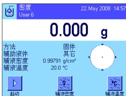
如果您使用水或酒精以外的其它辅助液体，则激活“辅助密度”功能键，并使用这个键输入您在当前温度下使用的辅助液体的密度（g/cm<sup>3</sup> 为单位，最多 5 个小数位）。必须执行这一操作，因为天平只存储水和酒精的密度表。输入的值显示在具有相同名称的信息字段中，还必须激活这些字段。**注意：**如果您正在使用水或酒精以外的其它辅助液体，则不需要使用左边示例中激活的“辅助温度”功能键，以及具有相同名称的信息字段。但如果您需要，也可以用这个功能键输入当前环境温度，以便将其打印在作为测定密度的温度记录的报告上。
