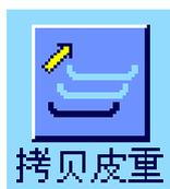
您可以使用“拷贝皮重”功能键将第一个样品的皮重值应用于系列中还没有定义皮重值的所有其它样品（原有的皮重值被保留！）。如果您在称量所有样品时都使用同一个皮重容器，那么这将会节省相当多的时间。
