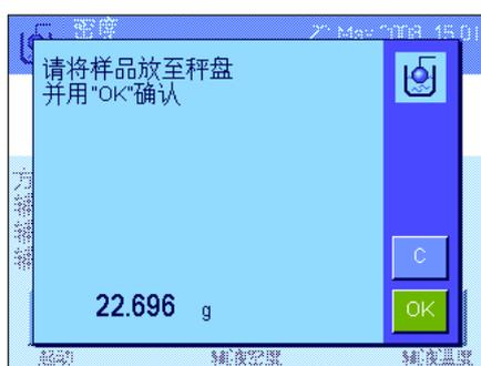
按“启动”功能键以开始密度测定。天平执行一次自动去皮重操作，然后提示您将固体放在天平上，以便在空气中称量。
