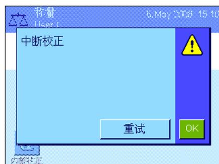
**中断校正。**当您取消校正时,还会显示该信息。您可以重复校正操作或按“OK”以返回应用状态。
