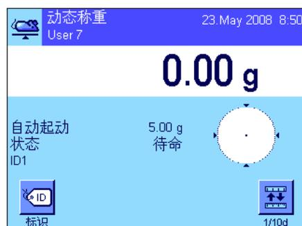
将称重物放在天平上。称重物的质量必须大于“自动启动”信息字段中显示的质量，否则称量周期不会自动开始。自动启动后，将显现左边所示的窗口。
