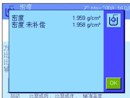
天平此时开始测定液体的密度并显示结果。根据您的结果显示屏所做的设置，显示补偿结果、未补偿结果或同时显示二者（参见第 10.3.5 节）。
