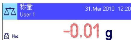
在左图中，称量结果（状态图标）上方的小质量图标和灰色质量值表示尚未达到最小初始质量，以及当前质量值可能超出质量保证体系中规定的容差范围。
