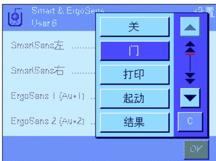
“起动”和“结果”可模拟具有相同名称的功能键。“OK”可模拟按密度测定对话框（而不是菜单中）中具有相同名称的键，以确认输入和操作。如果这些设置中有一个被激活，对应传感器下的状态栏中的绿色“F”（功能）符号将点亮。
