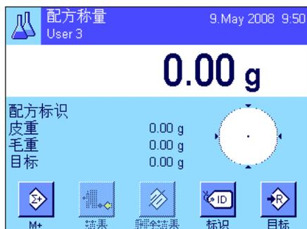
在选定应用程序后，会出现左边的显示屏。出厂时用于配方称量程序的专用功能键和信息字段处于激活状态。可以根据下面各节中的描述，使用这些设置和其他设置来适应您的要求。
