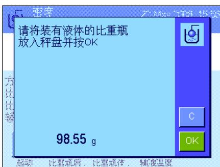
按“**启动**”功能键,以开始密度测定。然后天平将提示您放置装有液体的比重瓶(选定比重瓶的质量显示在窗口的左下角并带一个负号)。
