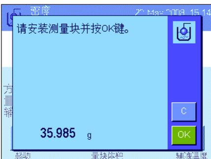
按“启动”功能键以开始密度测定。天平随后提示您安装液体密度测量块（在空气中称量以定皮重）。
