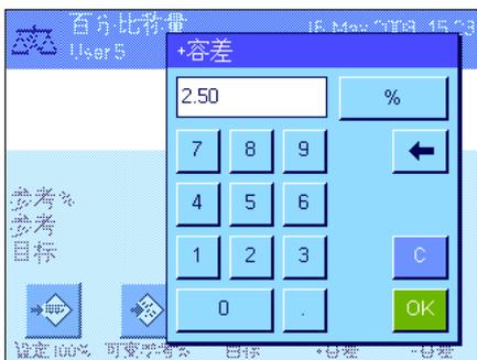
输入目标值和容差后，图形称量辅助工具（动态图形显示器“SmartTrac”）的容差标记即出现在显示屏中。容差标记可使按目标值进行称量的操作变得更容易。您可以大致称量样品，直到出现较低的容差值，然后如有必要，再精确按目标值称量。
