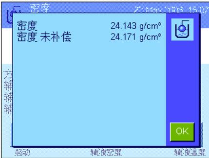
天平此时开始测定固体的密度并显示结果。根据您的对结果显示屏所做的设置，显示补偿结果、未补偿结果或同时显示二者（参见第 10.3.5 节）。
