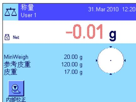
按《→0←》键将显示屏设置为零。将皮重（衡量容器）放在秤盘上并按《→T←》键以称量天平皮重。天平测定皮重值，并将其显示在“皮重”信息字段中。“Net”图标（净值）出现在称量显示屏旁边。
