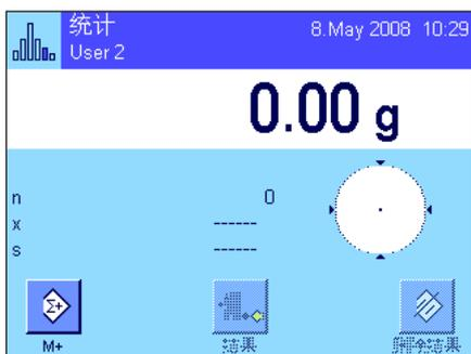
在选定应用程序后，会出现左边的显示屏。出厂时一些用于统计的专用功能键和信息字段处于激活状态。可以根据下面各节中的描述，使用这些设置和其他设置来适应您的要求。
