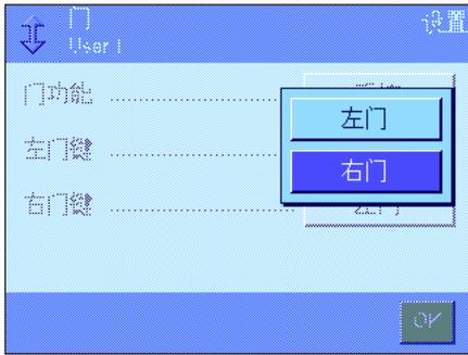
“左门键 ↵/右门键 ↵” (仅限配有旋转门的微量天平)
