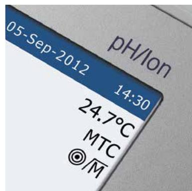
图2：pH计显示的温度和MTC标示
